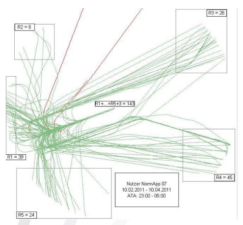
Abbildung 29: Standardisiertes Anflugverfahren –Ostbetrieb 23:00 bis 05:00 Uhr. Quelle: Umwelthaus
