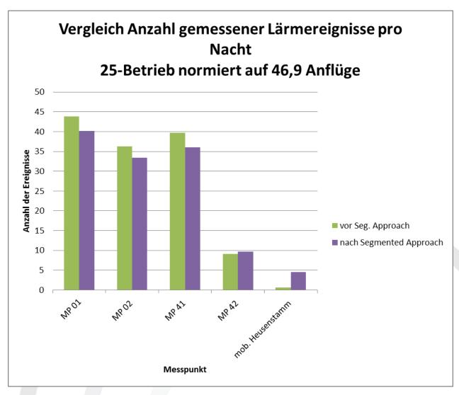
Abbildung 26: Vergleich der Anzahl der gemessenen Fluglärmereignisse pro Nacht bei 25-(West-) Betrieb, Zu Vergleichszwecken wurde die Anzahl der Anflüge pro Nacht vor und nach der Einführung des Segmented Approach auf 46,9 normiert. Quelle: Fraport
