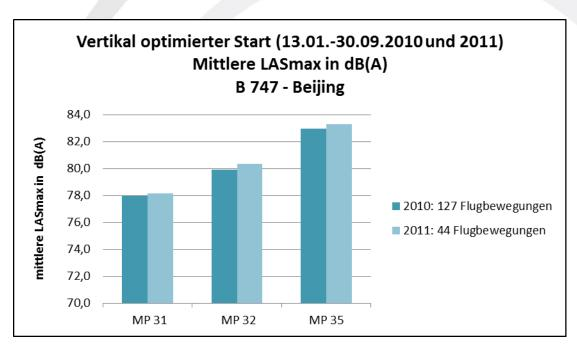
Abbildung 11: Vertikal optimierter Start, Mittlere LASmax, B747, Beijing. Quelle: Fraport
