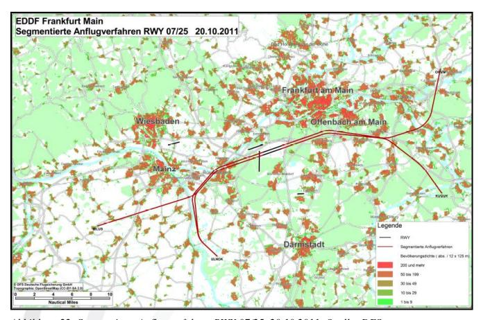
Abbildung 22: Segmentierte Anflugverfahren RWY 07/25, 20.10.2011. Quelle: DFS.
