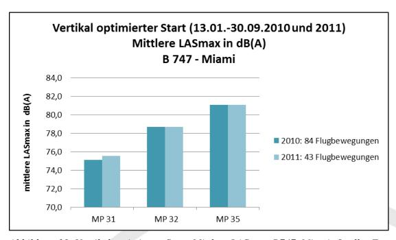
Abbildung 10: Vertikal optimierter Start, Mittlere LASmax, B747, Miami. Quelle: Fraport
