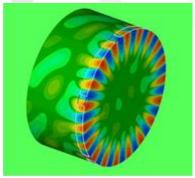
Abbildung 16: CFM 56-3 Triebwerk vor der Umrüstung. Simulation und schematische Darstellung der Ausbreitung bestimmter Schallfrequenzen im Triebwerk. Quelle: DLR, Institut für Antriebstechnik, Abt. Triebwerksakustik
