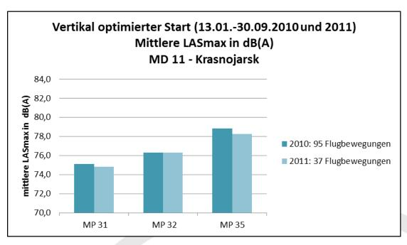
Abbildung 14: Vertikal optimierter Start, Mittlere LASmax, MD 11 Krasnojarsk. Quelle: Fraport
