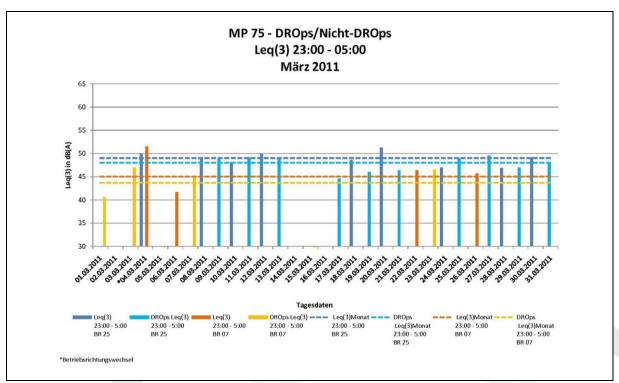
Abbildung 36: Messpunkt 75 (Gräfenhausen) – Leq (3) 23:00 Uhr bis 05:00 Uhr, Vergleich DROps/Nicht-DROps, März 2011. Quelle: Fraport
