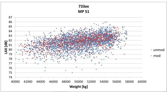
Abbildung 19: 737-300 Messwerte für Starts am Messpunkt 51. Quelle: Lufthansa
