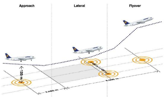
Abbildung 18: Schematische Darstellung Zertifizierungsmessung. Quelle: Lufthansa
