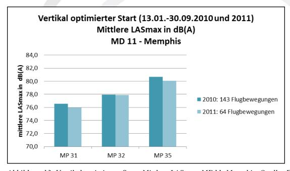
Abbildung 13: Vertikal optimierter Start, Mittlere LASmax, MD11, Memphis. Quelle: Fraport
