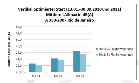
Abbildung 6: Vertikal optimierter Start, Mittlere LASmax, A330-200, Rio de Janeiro. Quelle: Fraport
