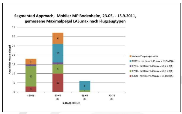
Abbildung 28: Segmented Approach, Mobiler MP Bodenheim, Maximalpegel nach Flugzeugtypen. Quelle: Fraport
