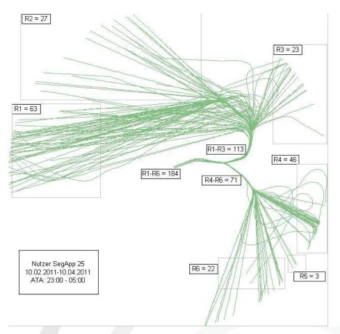
Abbildung 32: Segmentiertes Anflugverfahren-Westbetrieb – 23:00 bis 05:00 Uhr. Quelle: Umwelthaus
