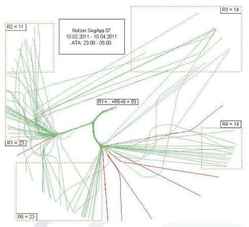
Abbildung 30: Segmentiertes Anflugverfahren-Ostbetrieb – 23:00 bis 05:00 Uhr. Quelle: Umwelthaus.
