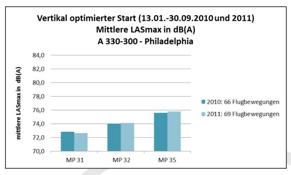
Abbildung 8: Vertikal optimierter Start, Mittlere LASmax, A330-300, Philadelphia. Quelle: Fraport
