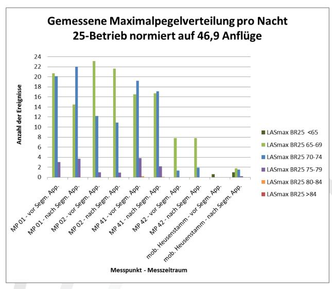
Abbildung 25: Vergleich der Maximalpegelverteilungen vor (17.12.2010 bis 18.01.2011) und nach (19.01.2011 bis 31.03.2011) Einführung des Segmented Approach. Quelle: Fraport
