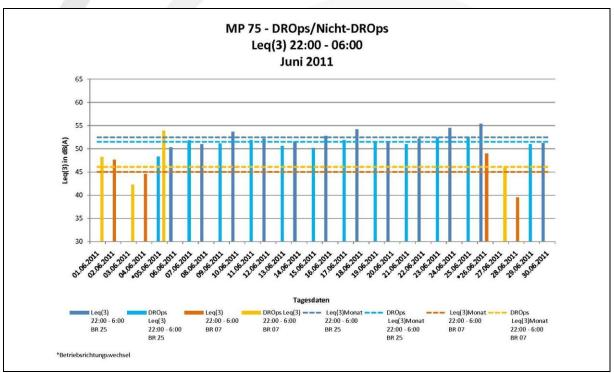
Abbildung 37: Messpunkt 75 (Gräfenhausen) – Leq (3) 22:00 Uhr bis 06:00 Uhr, Vergleich DROps/Nicht-DROps, Juni 2011. Quelle: Fraport
