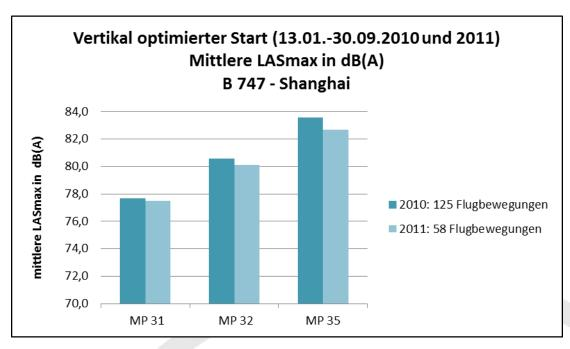
Abbildung 12: Vertikal optimierter Start, Mittlere LASmax, B747, Shanghai. Quelle: Fraport
