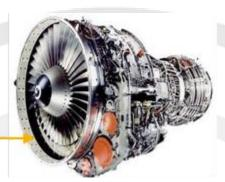
Abbildung 15: CFM 56-3 Triebwerk mit Acoustic Panels an der B737. Quellen: Lufthansa, CFM International (Triebwerkshersteller)
