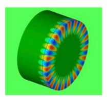
Abbildung 17: CFM 56-3 Triebwerk nach der Umrüstung. Simulation und schematische Darstellung der Ausbreitung bestimmter Schallfrequenzen im Triebwerk. Quelle: DLR, Institut für Antriebstechnik, Abt. Triebwerksakustik
