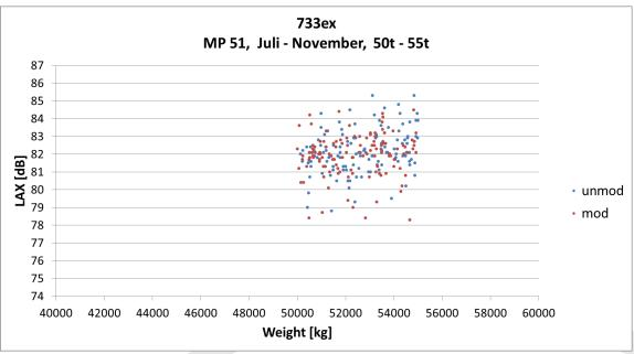
Abbildung 20: 737-300 Messwerte für Starts am Messpunkt 51, nur Ereignisse mit Startgewichten von 50 bis 55 Tonnen. Quelle: Lufthansa
