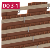
Doppeldeckung mit 415c, Befestigung zwischen jedem dritten Biber
