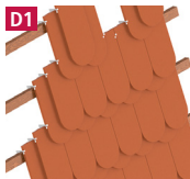
Doppeldeckung mit 425, Befestigung an jeder Latte
