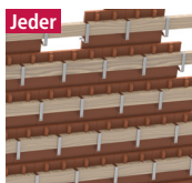
Doppeldeckung mit 415c, Befestigung zwischen jedem Biber
